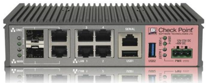
в агрессивных средах и соответствует промышленным стандартам IEEE 1613, IEC 61850-3 по температуре, вибрациям и воздействиям электромагнитного излучения. Высокая производительность (пропускная способность в режиме межсетевого экрана при смешанном трафике 700 Мбит/с и 60 Мбит/с в режиме IPS, пропускная способность VPN 450 Мбит/с) и централизованное управление являются преимуществами простого решения «все в одном».
