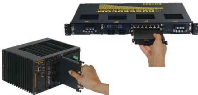
ступа к шине по интерфейсу GigE позволяет обойтись без применения лишних кабелей, а наличие дополнительных интерфейсов (1xGigE и 2xUSB) на внешней панели дает дополнительную гибкость применения.
