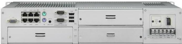
Check Point IAS U1 также имеет 2 интерфейса USB и интерфейсы для подключения консоли, клавиатуры и монитора и полностью интегрируется в систему централизованного мультидоменного управления Smart Center/Multi Domain.
